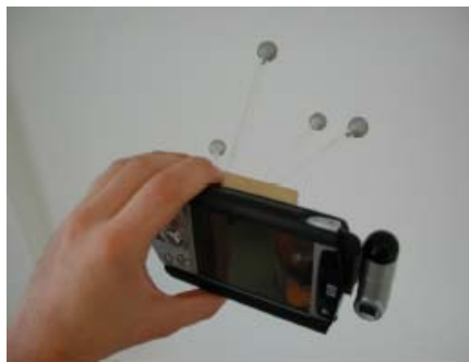
Figura 13 – Acessório de PDA para uso de rastreadores comerciais especializados: esferas retro-reflexivas funcionam como alvo para os sensores
