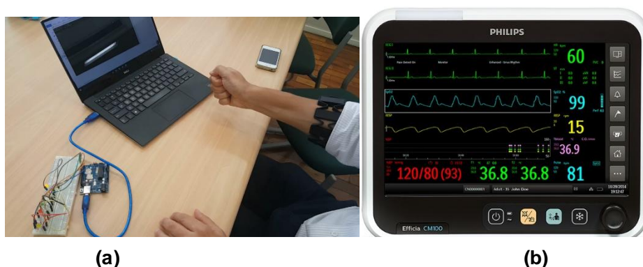
Figura 10. Myo sendo utilizado para verificar movimentos do braço e o Monitor Philips CM 100 .
