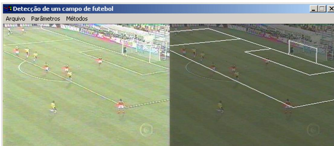
Figura 7.2 – Detecção de um campo real (imagem nº 23 de uma seqüência).
