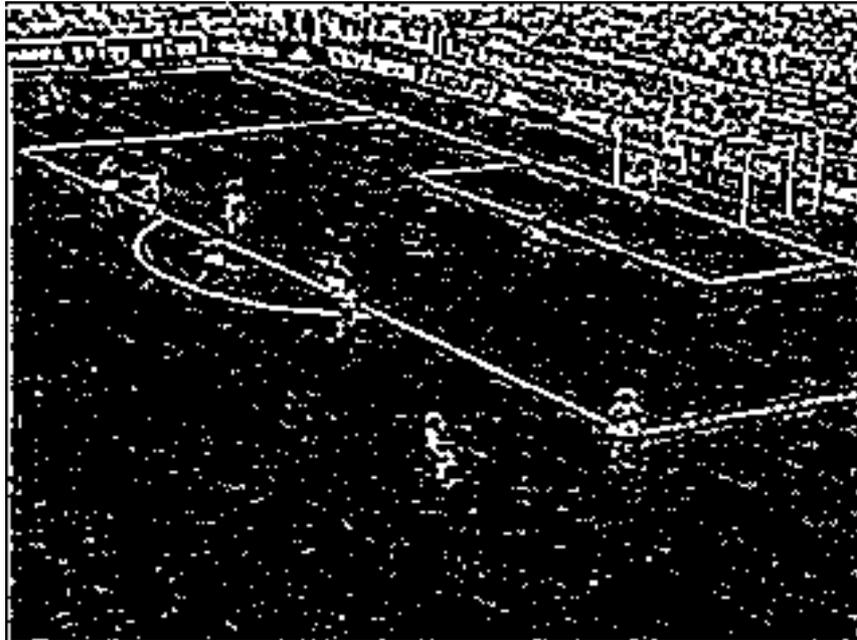
Figura 2.15 –Segmentação por limiar aplicado à Figura 2.8 utilizando o método de Otsu.
