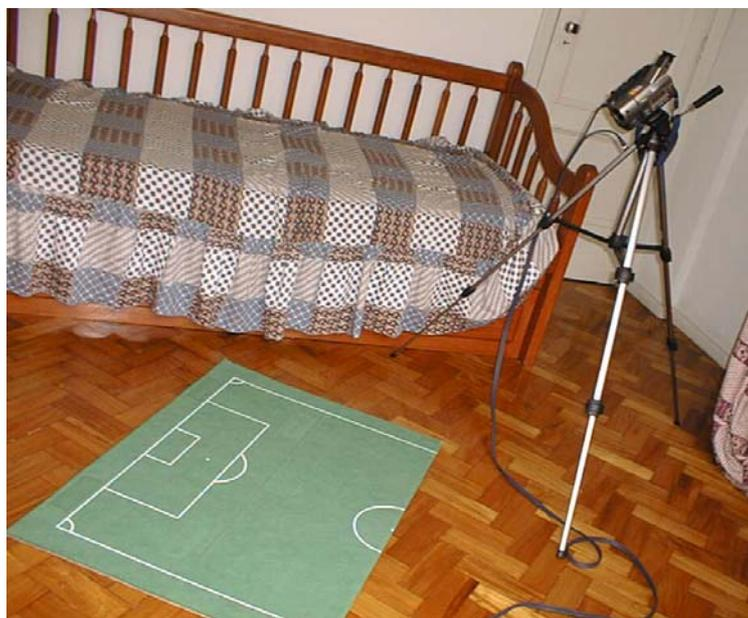
Figura 7.12 – Protótipo para testar o algoritmo usando uma câmera 8mm.
