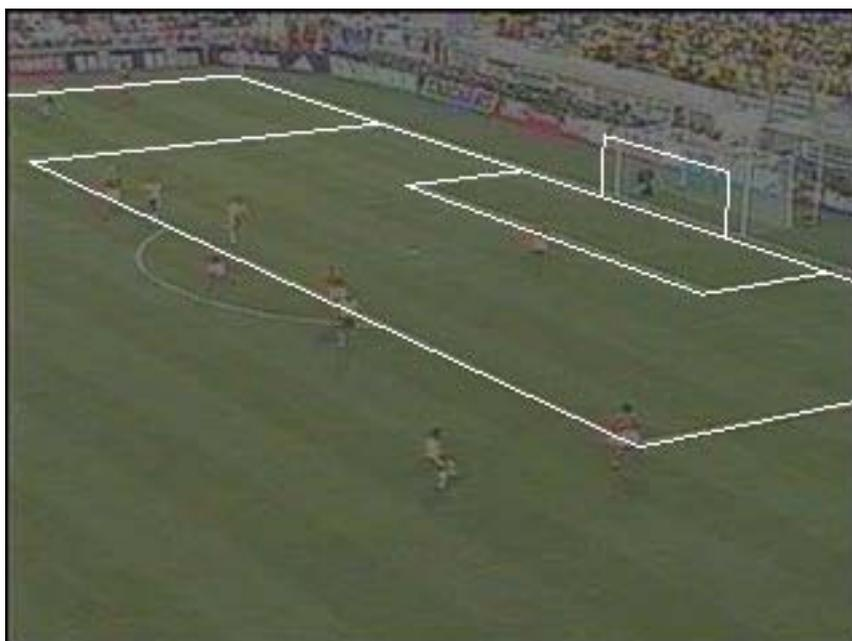
Figura 6.4 – Projeção do modelo segundo a câmera calibrada no passo A5, com objetos fora do plano do modelo.
