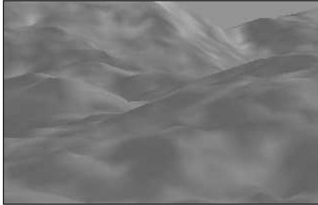
Figura 2.4 - Terreno visualizado através de uma TIN texturizada
