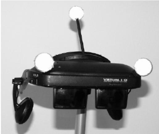
Figura 15: HMD rastreado por esferas retroreflexivas.
